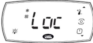
2. PRG drücken: Zugang zum Anzeigemodus der aktiven Aktoren/Funktionen.
