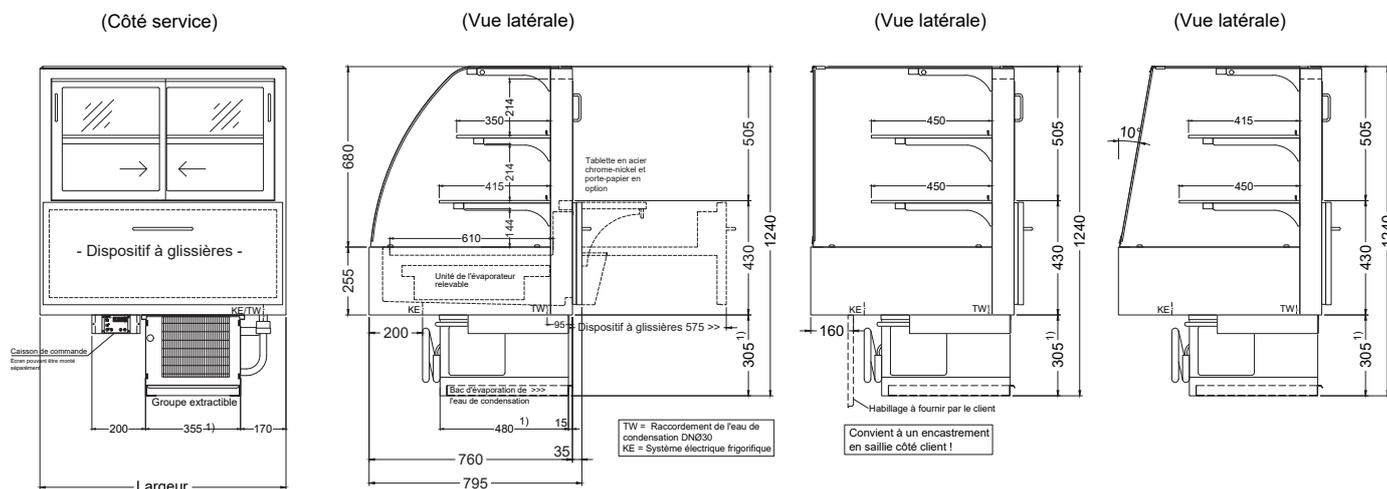
1) Modèle « BAK L G-132-68-E » avec dimensions du compartiment du groupe: (LxPxH) 370 x 520 x 350 mm
